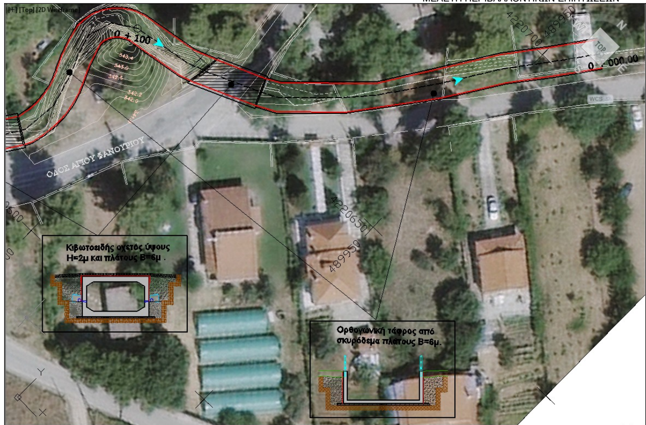
Εικόνα 7.2.2: Προτεινόμενα έργα διευθέτησης στην αρχή του μελετούμενου τμήματος του ρέματος
